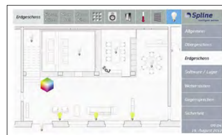
Abbildungen: Beispiele von «Spline» Bedienoberflächen, die auf die jeweilige Situation angepasst ein einfaches und zentrales Bedienen der gesamten Haustechnik von der Wetterstation über Audio bis zu Licht usw. erlauben.
